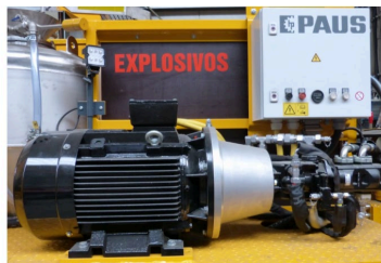
Abbildung 12: Komponenten der kabelelektrischen Sprengstoffladetechnik
