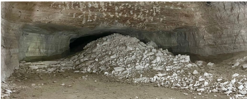
Abbildung 9: Sprengergebnis mit dem neuartigen granularen Sprengstoff in Zielitz
