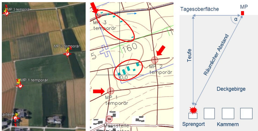
Abbildung 1: Übersicht des Testrevieres mit untertägigen Sprengbereichen und übertägigen Messlokalitionen MP 1 – 3 und Dauerüberwachungsstelle in der anliegenden Ortschaft
