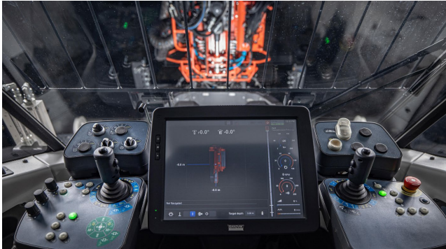
Abbildung 8: Steuerstand Sandvik Abbaubohrwagen
