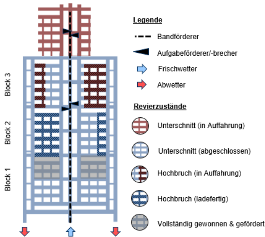
Abbildung 6: Beispielhafte Entwicklung und Betriebszustände eines Kombinationsreviers mit zwei Continuous Minern
