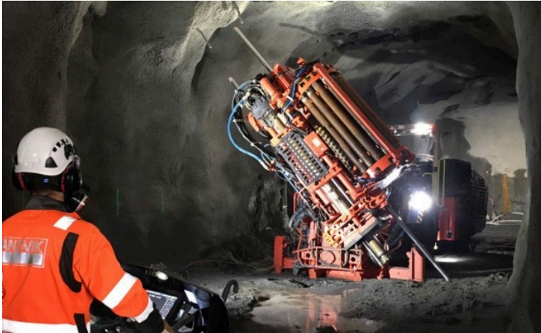
Abbildung 3: Langlochbohrgerät mit Senk-Bohrhammer der Firma Sandvik
