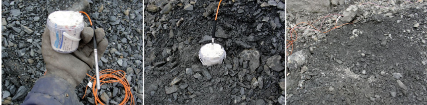
Abbildung 7: nachträgliche Sprengung eines Teils einer Versagerpatrone
