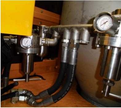
Abbildung 5: Druckluftbeaufschlagung des ANFO-Behälters
