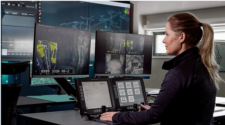
Abbildung 6: Kontrollstand für Langlochbohrgeräte [Epiroc]
