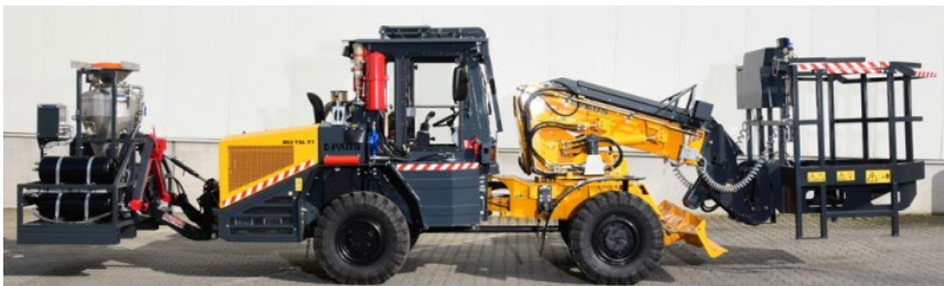
Abbildung 3: TSL 853 Geräteträger mit Sprengstoffladegerät und Arbeitsbühne
