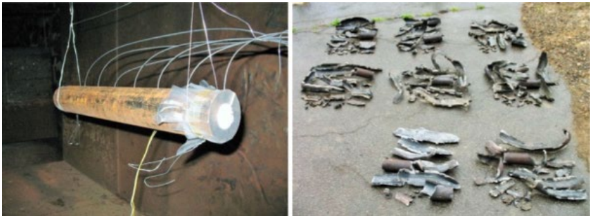
Abbildung 6: Stahlrohrsprengung in Sprengtunnel der MSW-Chemie GmbH
